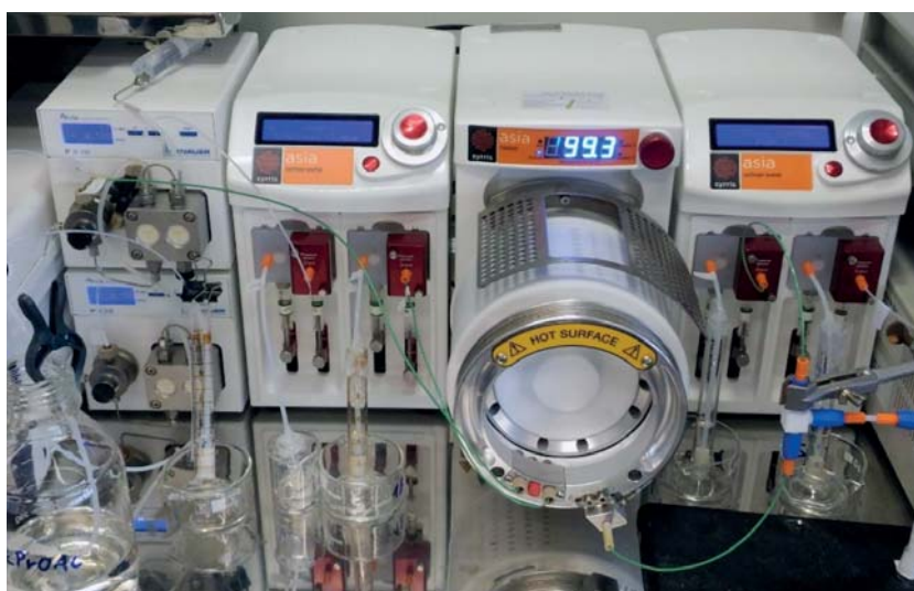
32. ábra. A HPLC- és fecskendőpumpák, középen az R2 csőreaktorral
