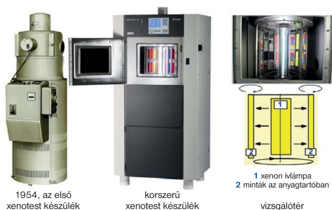
11. ábra. Xenotest készülékek és működésük
