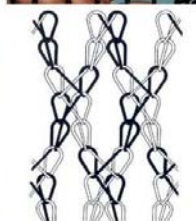
csomómentes, raschel-gépi, láncrendszerű kötött háló
