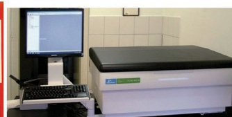
folyadékcintillációs spektrométer a szén radioaktivitásának mérésére
