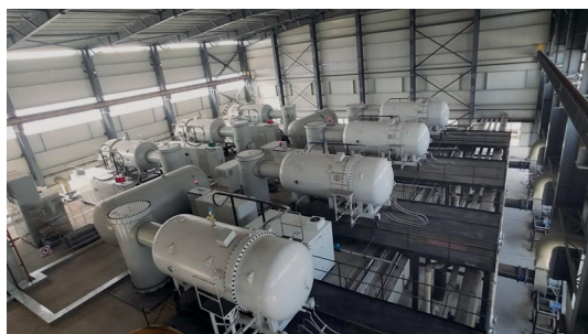
10. ábra. Ipari szennyvíz kezelése gamma-besugárzással ( 60 Co)
