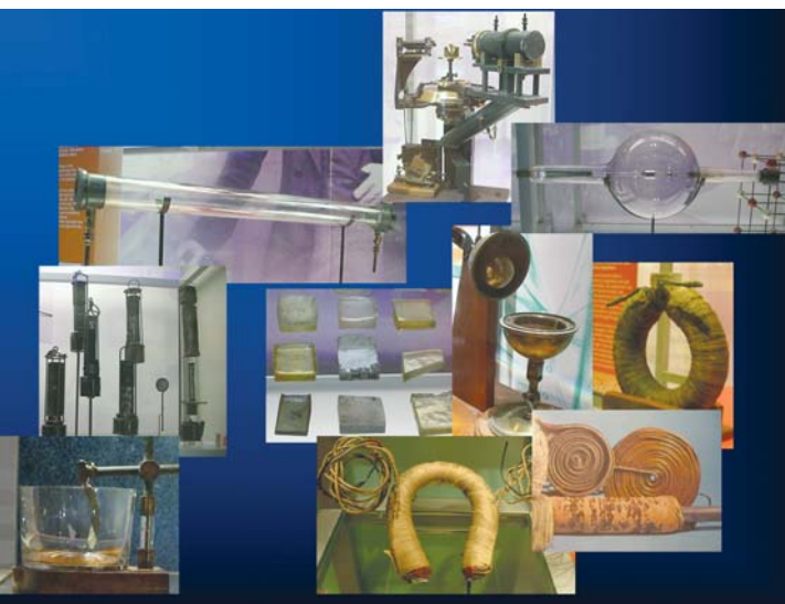
12. kép. Davy elektrolizáló cellája, biztonsági bányászlámpái, Tyndall fényszórást vizsgáló üvegcsőve, Rayleigh spektroszkópja, Bragg röntgencsőve, Faraday optikai üvegei, valamint elektrosztatikai és indukciós kísérleti eszközei
