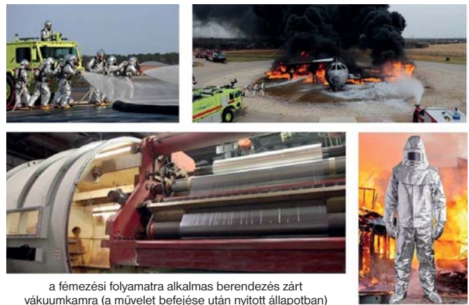
16. ábra. Reptéri tűzoltó védőruházat borítórétegének előállítása és a kész öltözék
