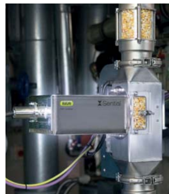
4. ábra. Büchi online NIR-készülék gyártósorba építve
