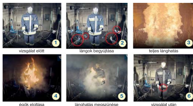
10. ábra. BTTG égetési teszt szenzoros próbababun (120 s)
