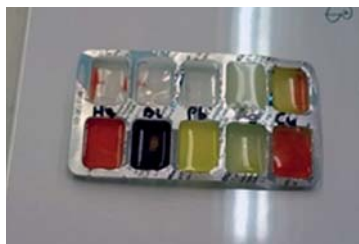
3. ábra. A tablettartató mint reakciótér
