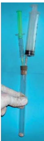
2. ábra. Acetilén előállítás kalcium-karbid és víz reakciójával
