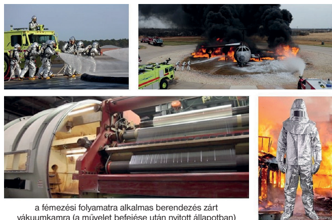
16. ábra. Reptéri tűzoltó védőruházat borítórétegének előállítása és a kész öltözék
