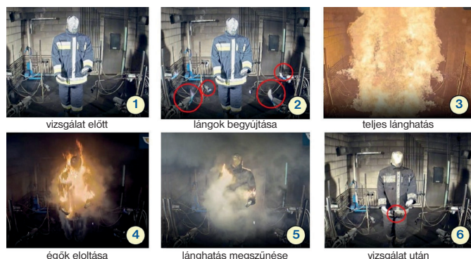
10. ábra. BTTG égetési teszt szenzoros próbababun (120 s)
