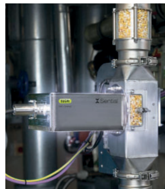
4. ábra. Büchi online NIR-készülék gyártósorba építve
