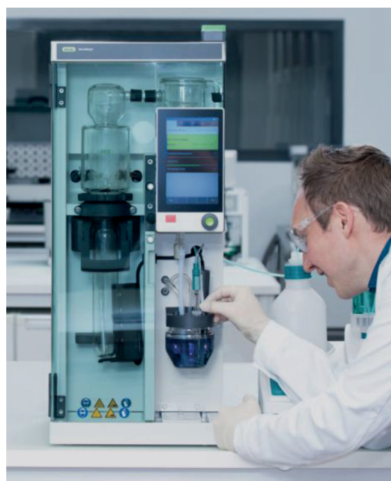
1. ábra. Büchi K-365 desztillálókészülék titrálóedénnyel
