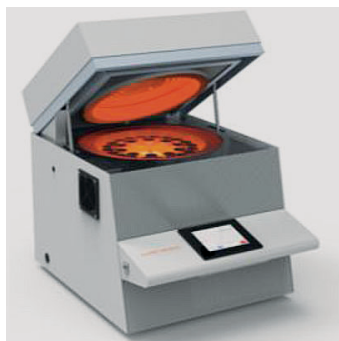
7. ábra. Precisa PrepASH TGA készülék
