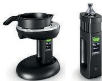
6. ábra. Büchi ProxiScout hordozható NIR-készülék asztali mérés közben
