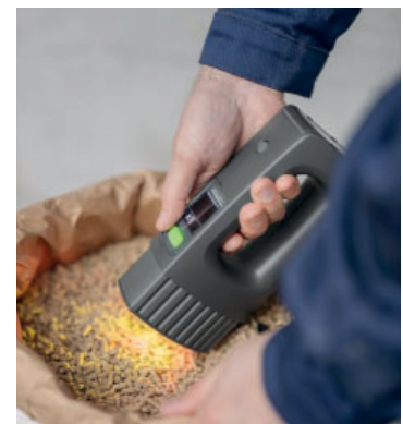
5. ábra. Büchi ProxiScout hordozható NIR-készülék
