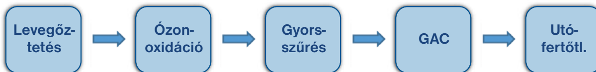
3. ábra. A parti szűrés technológiai sora (nagy vas- és mangánkoncentrációk esetén)
